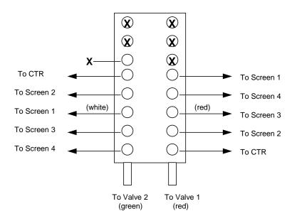
Figure II-4. Air Manifold
